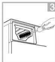
Entfernen Sie alle Rückstände mit einer weichen Bürste
