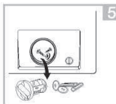
Entfernen Sie Gegenstände aus dem Sieb und dem Schacht. Das Flusensieb kann mit Wasser gewaschen werden.
