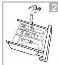
Waschmittellade und Weichspülerabdeckung unter Wasser reinigen
